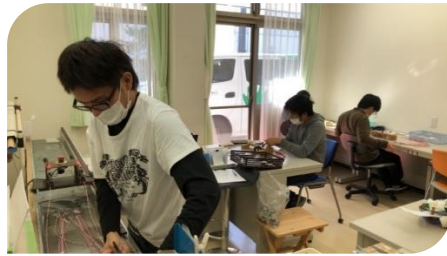
ツイスト線のテープ巻き作業と機械操作（大熊工業）
