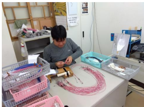
ツイスト線のテープ巻き作業 (大熊工業) とポスティング (サンデー西京・ほっぷ)
